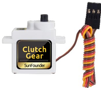
SunFounder SF0180 サーボは 180 度の 3 線式デジタルサーボである。60Hz の PWM 信号を利用し、物理制限はない。最大 180 度までの内部ソフトウェアのみによって制御される。
